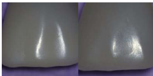
Рисунок 6. Сравнение отполированной поверхности образцов 2-ой пары (слева направо – со смолой и без)
